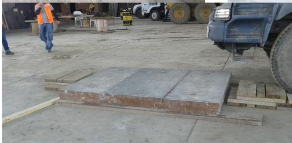
Tapas de alta carga con ensamble lateral entre ellas para soporte en vacío. Prueba de carga – Firma OHL – Aeropuerto BONILLA ARAGON
