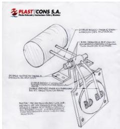
Esquema de Compuerta Basculante para recuperación de aguas negras a PTAR
