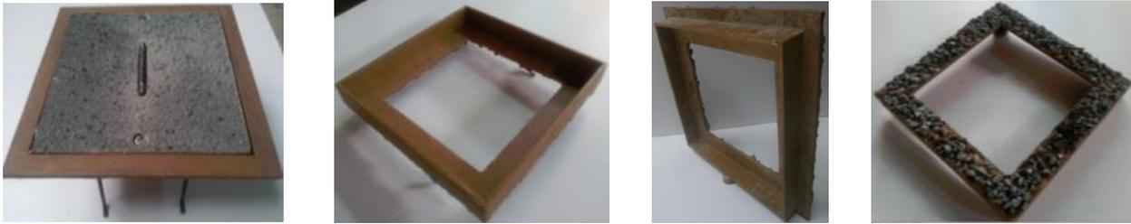
Marcos de fundición monolítica en molde, con ganchos de anclaje y piedra para mayor agarre con el concreto de la cámara.
