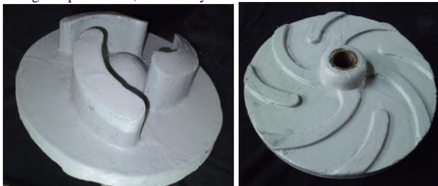
Revestimiento de Impulsores para Bombas con Líquidos Corrosivos Contaminados, de Proceso u otros
